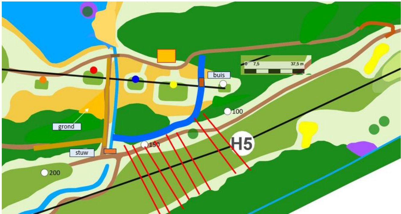
Fase 2 : Het aanbrengen van drainage in de zomer 2025
